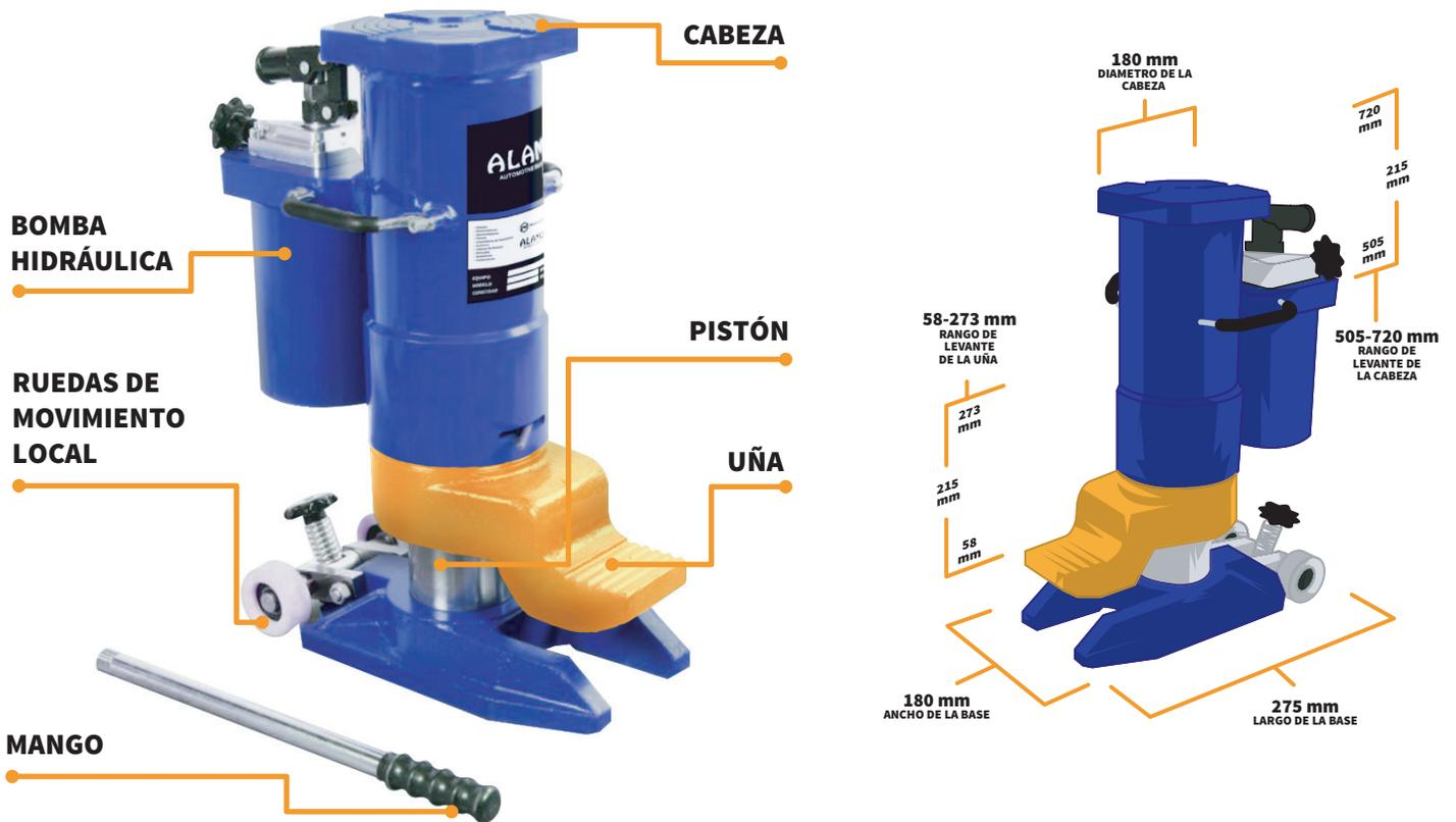
El Gato Industrial de Uña Álamo® funciona con un sistema hidráulico con un recorrido de 215 mm, de construcción robusta, Pesado y Fuerte. De diseño versátil para adaptarse a espacios con altura reducida. Puede colocarse en diferentes posiciones y ángulos. Su estructura esta reforzada de acero, con levante ya sea por la Cabeza del gato así como por la Uña. El descenso es preciso y ajustable. Es la herramienta ideal para levantar todo tipo de Maquinaria y Estructuras Metalicas.
